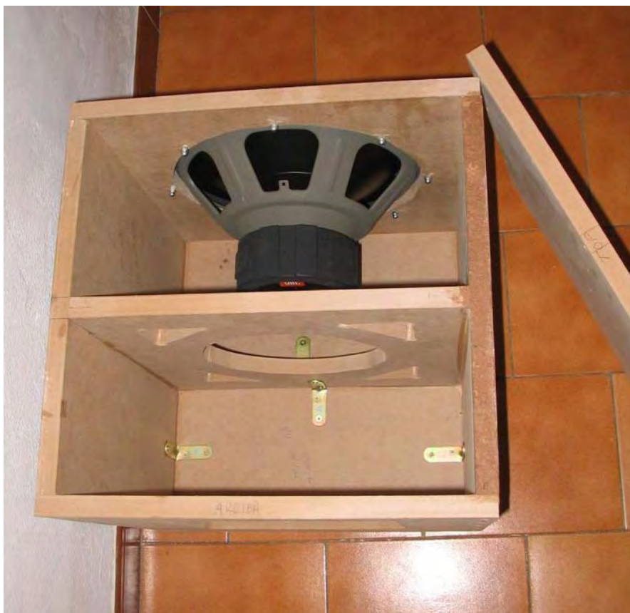
Foto: Pruebas con taladros de enganche del transductor.
